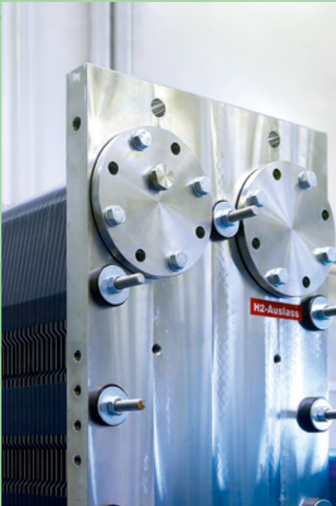
Teilausschnitt eines Elektrolyseurs mit Wasserstoff-Auslass.
